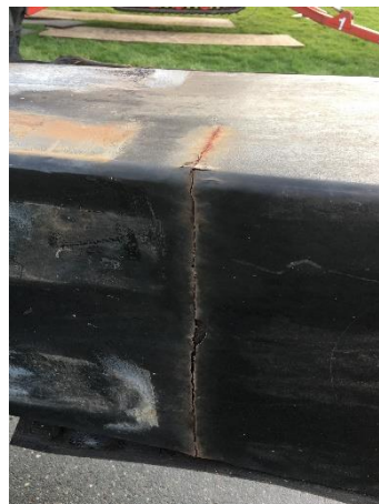
Foto bij 31a+b – Voorbeelden van lijnvormige roestvorming betekende in deze gevallen risicovolle scheurvorming
